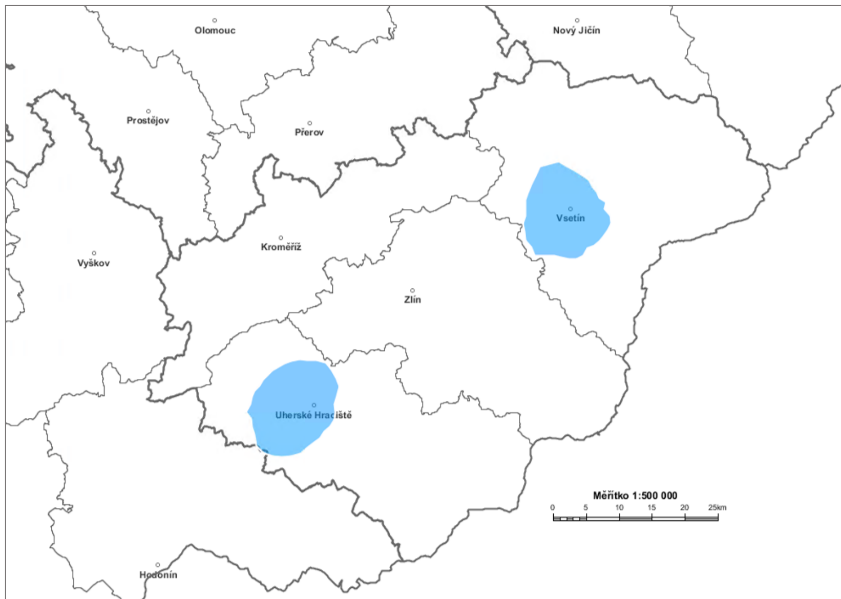
Diagram využití rádiových kmitočtů určených pro analogové vysílání v pásmu VKV pro vysílače UHERSKÉ HRADISTĚ 98,3 MHz a VSETÍN 105,7 MHz stanovený výpočtem podle vyhlášky č. 22/2011 Sb. (modrá barva).
